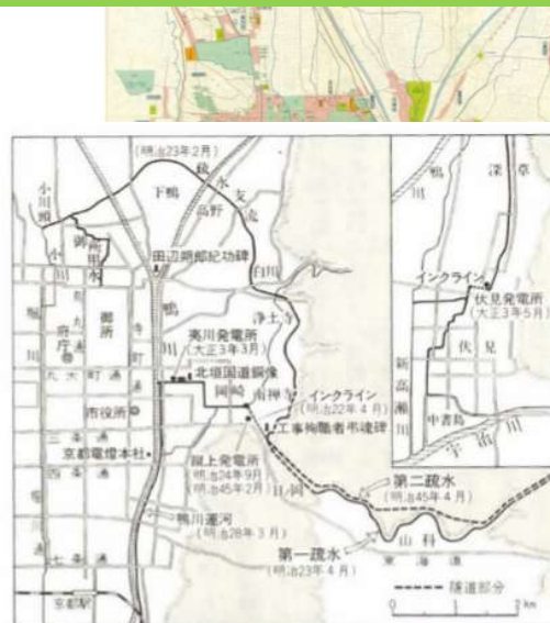
図 56 疎水の流路 第1・第2疎水及び幹・支線の流路を図示している。幹線はインクライン・鶴東運河を経て伏見に至り、支線は蹴上から市街の北方を迂回し、灌漑用水や御所用水を分水して堀川に合する。
